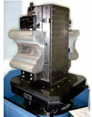
Art. 53D Cubo per piastre riportate con montate piastre ed elementi modulari con sovraganasce Tombstone with modular plates, fixed and movable vise sections and stack type jaws assembled
