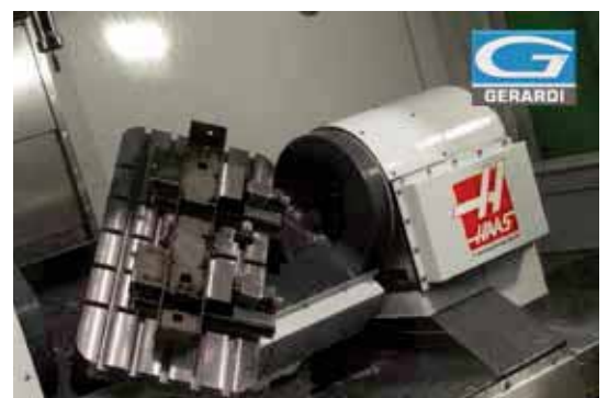
Morse Art.1 montate su tavola basculante per macchina a 5 assi Art.1 vises assembled on a dividing head for a 5 axis machine
