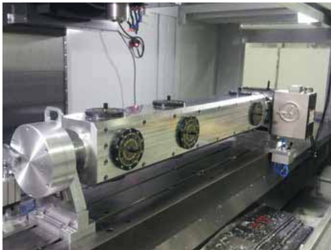
Special aluminum zero point fixture on Haas machine and rotary table Attrezzatura speciale con zero point applicata su tavola girevole e macchina Haas
