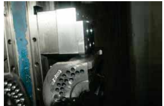
Cubomorsa FMS con ganasce speciali per presa stampi di bottiglia FMS vise tower with special jaws to clamp bottle moulds
