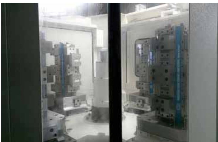
Cubimorsa FMS su centro di lavoro orizzontale FMS Visecubes on horizontal machining centre
