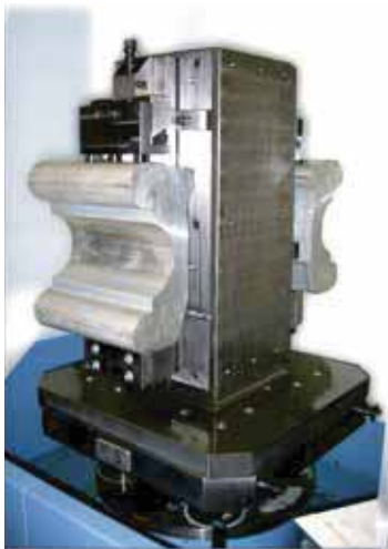
Cubo per piastre riportate con montate piastre ed elementi modulari con sovraganasce Tombstone with modular plates, fixed and movable vise sections and stack type jaws assembled
