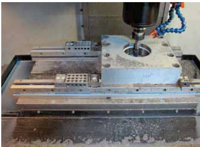
Morse Multiflex Art.611 Tipo 1x700 mm con ganasce doppie montata su centro di lavoro Haas VF-2 longitudinalmente rispetto alla tavola. Multiflex vises Art.611 Type 1 x 700 mm with double jaws shown on a Haas VF-2 machining centre along the X travel
