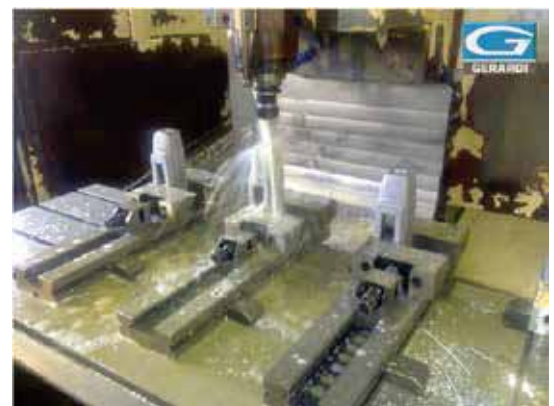
Morse modulari montate verticalmente su cubo portapezzi per lavorazioni su centro orizzontale Modular Vises vertically assembled on a tombstone for horizontal machining centre.
