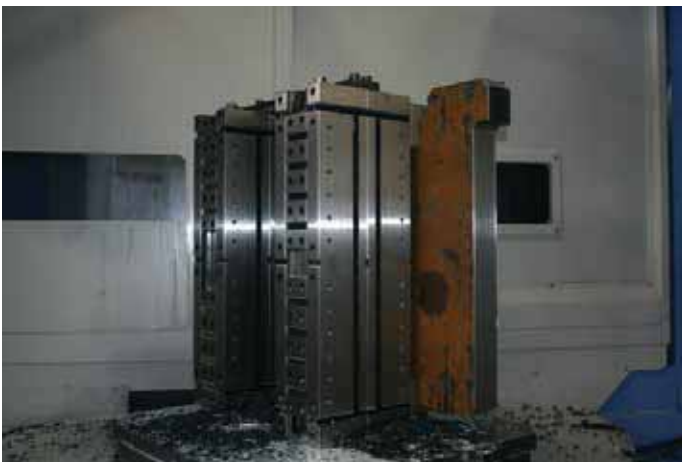
Esempio di massima capacità di presa pezzo delle morse FMS per un miglior utilizzo delle corse del centro di lavoro orizzontale Example of FMS vises maximum clamping capacity for a better exploit of the machining center runs
