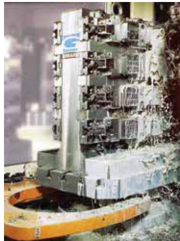
Morse XL doppie montate su spalla in orizzontal XL double vises horizontally assembled on a 2 sides tombstone
