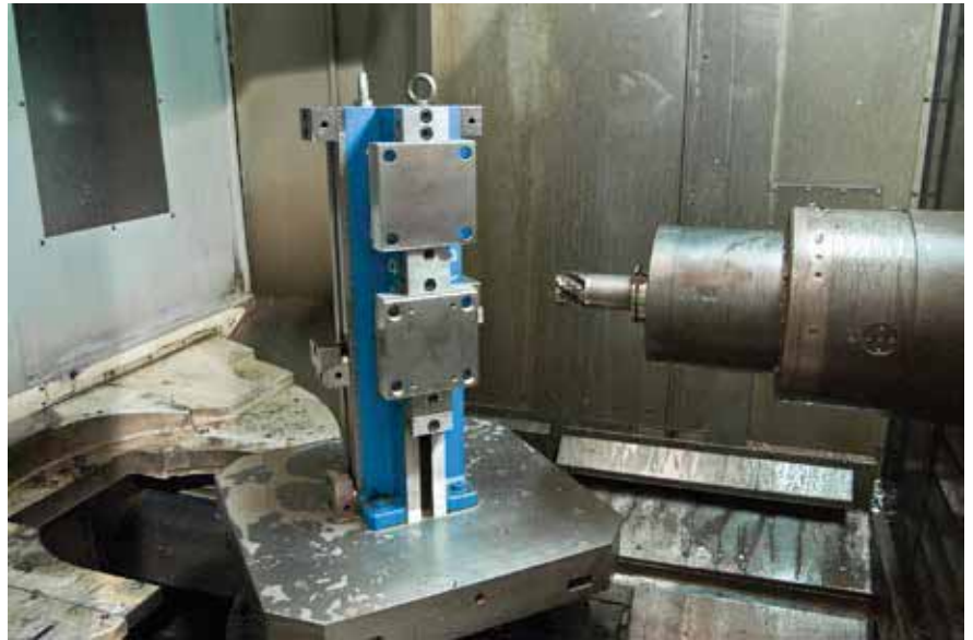
Particolari fuori dimensione ma lavorati su cubo Multiflex Art.607 tipo 2 - Rather big work-pieces machined on a Multiflex vise tower Art.607 Type 2_pic2
