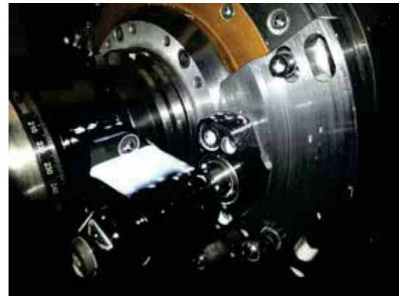
Stop block fissato sul madrino grazie ad uno SPECIALE Distanziale tra mandrino macchina e stop block Stop block fixed on the machine spindle thank to a SPECIAL Spacer between the machine spindle and the stop block
