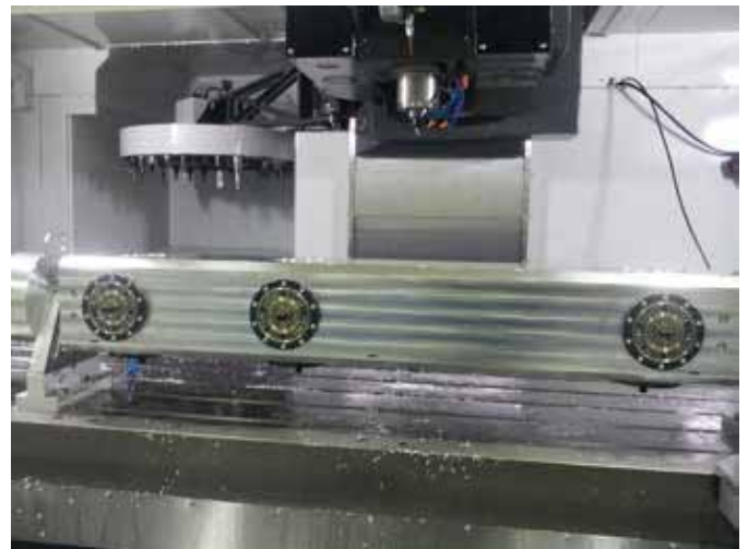
Special aluminum zero point fixture on Haas machine and rotary table Attrezzatura speciale con zero point applicata su tavola girevole e macchina Haas
