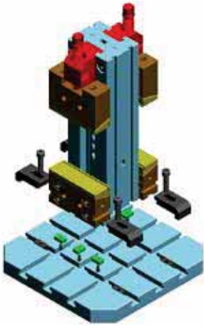
Ancoraggio e posizionamento con staffe e chiavette Positioning and clamping through vise clamps and keys nuts
