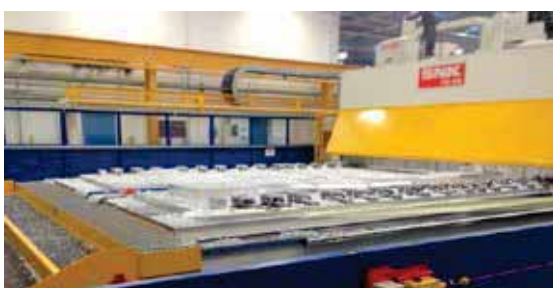
Morse standard automatizzate su una macchina con tavola lunga 30 metri Automated standard Vises on a 30 meter long machine tool
