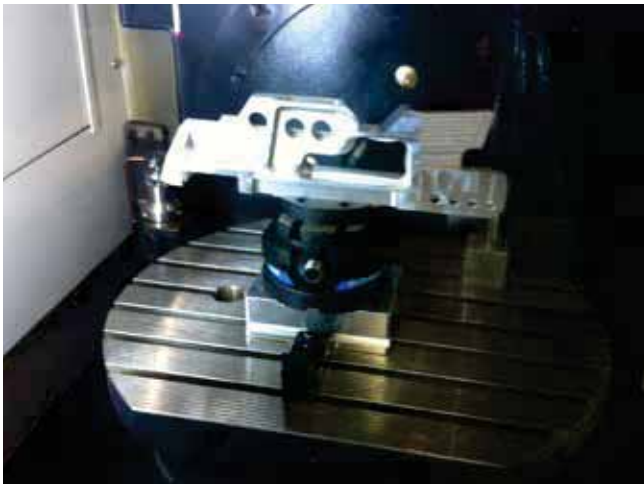
Applicazione per aeronautica Morsa Multitasking e Zero point montati su macchina DMG modello DMU 50 Ecoline Aerospace application for Multitasking Vise and Zero Point on DMG machine DMU 50 Ecoline Model
