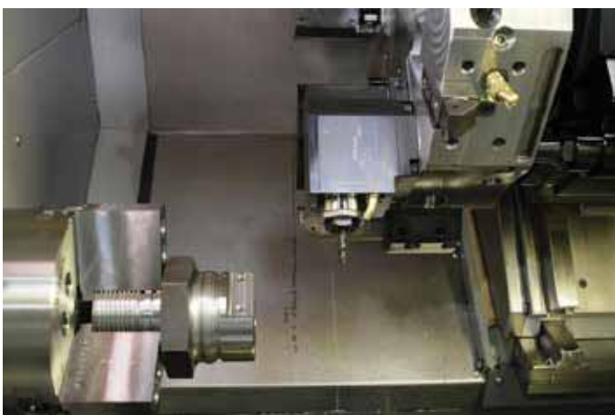
Macchina Haas ST20Y equipaggiata con motorizzati Gerardi Haas ST20Y machine with Gerardi driven tools equipment
