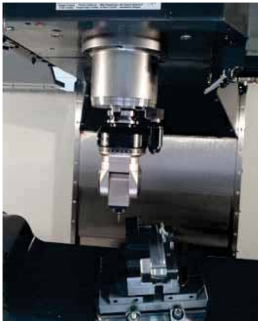
Testa orientabile montata su macchina Haas Haas machine center with universal angle head
