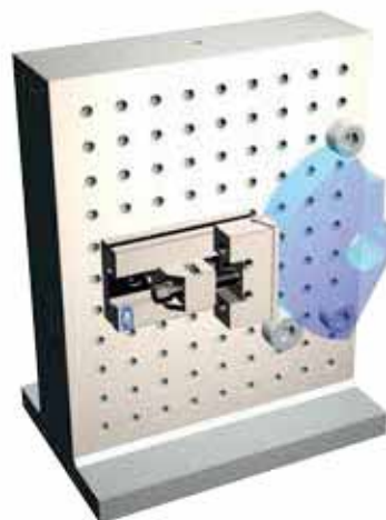
Particolare appoggiato direttamente sul piano spalla e serrato tramite una sezione mobile Art.102 e n.3 appoggi fissi. Workpiece positioned directly on the tombstone and clamped through 1 movable section art.102 and n.3 fixed reference points.
