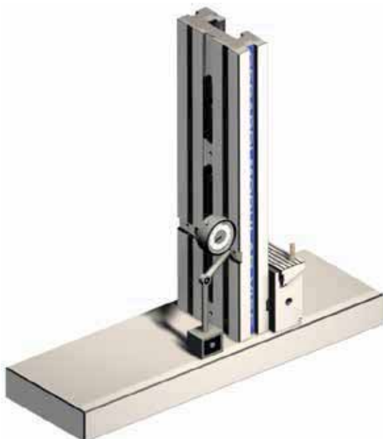
Miglior controllo per verifica allineamento morsa (ganasca fissa - chiave trasversale) Best check for vise alignment accuracy (fixed jaw - cross key)
