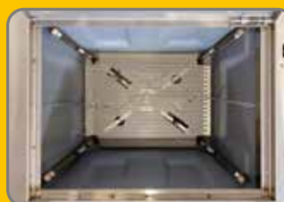
Vue de dessus de l'évier avec 2 supports pour pistolets à peinture et 2 pour godets à peinture.
